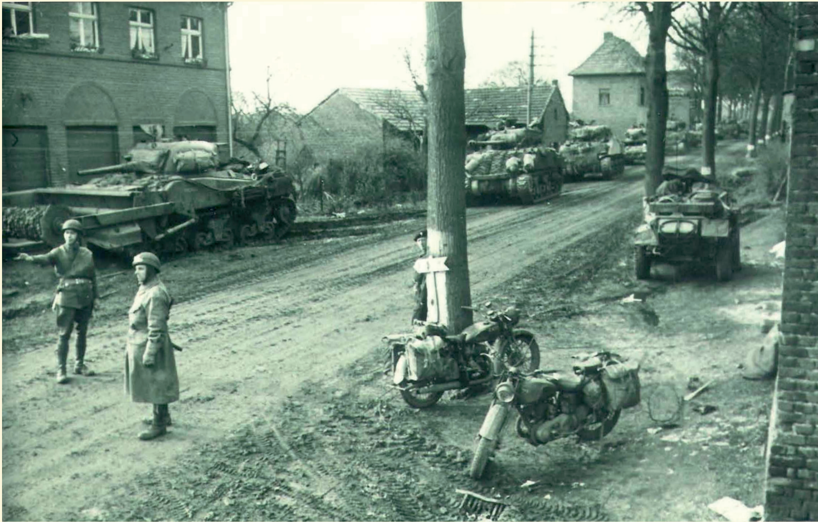
Alliierte Panzereinheiten in Gillrath an der Kreuzung Karl-Arnold-Str. / Auf der Weide / Hahnweg. Gegenüber das ehemalige Lebensmittelgeschäft Gerads, davor ein Dreschflegelpanzer zum Minenräumen.
